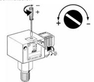
Fig. 4. Ajuste de la presión de conmutación
