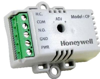
Der Sensor HCP00-EU zum Verhindern von Kondensation nutzt einen praxisbewährten Sensor in Kombination mit einem eng gekoppelten Präzisionsthermistor, um frühzeitig vor Bedingungen in Anwendungen mit Kühlbalken oder Kühldecken zu warnen, die Kondensation begünstigen, und um ein Abregnen von Kondensat in Innenräumen zu verhindern. Der Sensor kann auch in beliebigen HLK-Anwendungen verwendet werden, in denen eine Kondensation verhindert werden muss.
