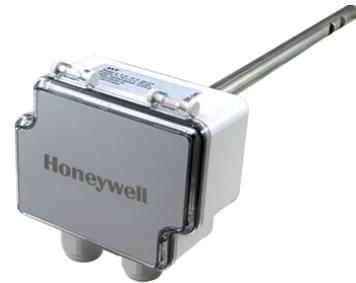
Die Produkte der Serie HAVDT sind für den Einsatz in gewerblichen Umgebungen ausgelegt. Sie verfügen über eine Sonde für die Kanalmontage und einen einstellbaren Bund für Leitungen mit rundem oder rechteckigen Querschnitt. Der Transmitter stellt unterschiedliche Messwerte für Luftgeschwindigkeit und Temperatur bereit. Er bietet drei Messbereiche in einem einzigen Gerät (0–2 m/s, 0–10 m/s, 0–20 m/s).
