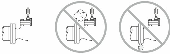
Abb. 2. Maßnahmen gegen Leckage
